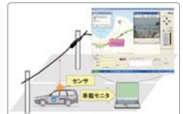
「ケーブル地上高測定システム」イメージ
