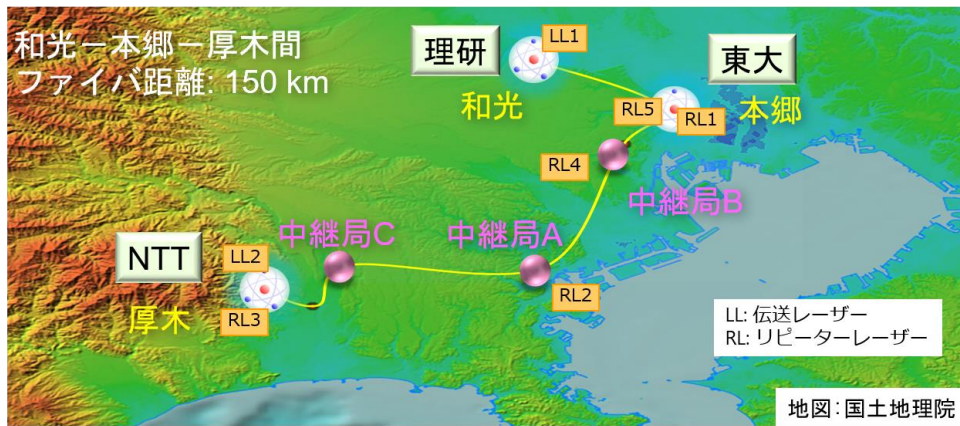
図2: 和光一本郷一厚木超高精度光周波数配信ファイバリンク
