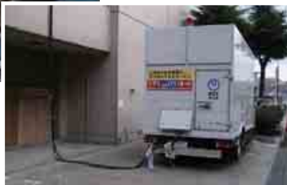
宮古ビルに横付けして給電する移動電源車 (岩手県宮古市)
