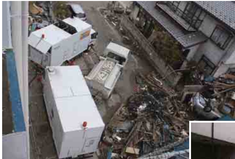
石巻門脇ビルを支えた移動電源車と給油用タンクローリー (宮城県石巻市)
