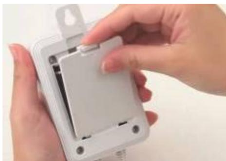
3. 電池カバーを取り付け、分電盤計測器を元あった場所に戻します。
