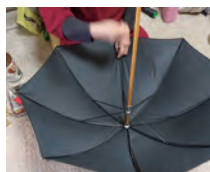
④中とじ 天紙布とカバーを石突からかぶせ、露先に骨を通し、骨とカバーを縫い付ける。
