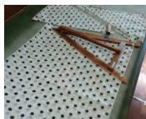
①三角裁断 傘の仕様に合わせて生地を裁断する。
