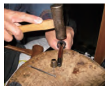
⑤陣笠取り付け 石突の根元に菊座と陣笠を取り付け、陣笠を鉚打ちで固定する。
