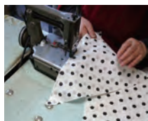
②中縫 裁断生地を親骨の本数に応じて縫合わせる。
