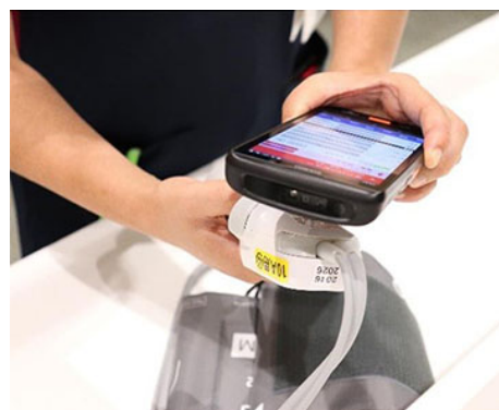
（写真1）モバイル端末をかざすだけで電子カルテへバイタルの自動入力が可能
