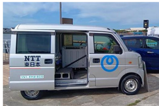
可搬型バッテリーを搭載したコンバージョンEV車
