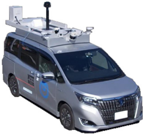
N電柱の傾き・たわみ測定車
