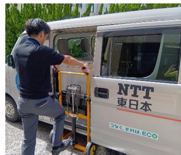
災害時には避難所にて バッテリーを降ろし、 電力供給が可能
