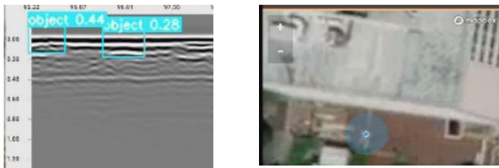
図5 情報操作側での地中レーダ検出結果(左)とロボットの位置(右)
