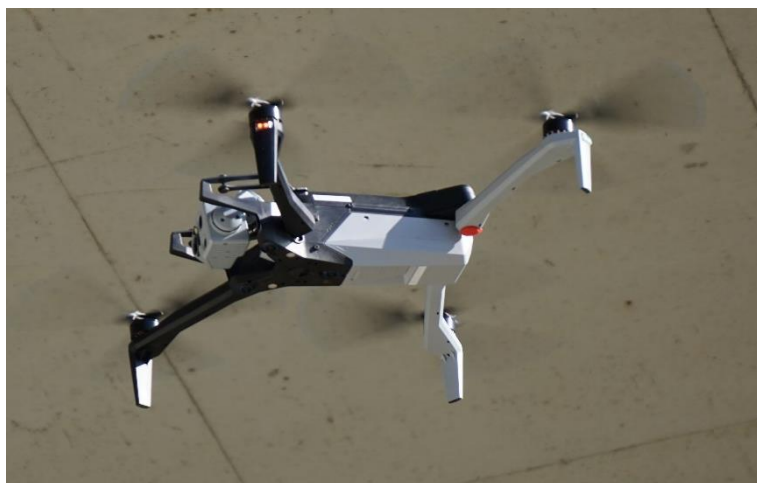
※2：Skydio 社製 「Skydio X10」 （点検・防災用途に活用しているオールラウンドドローン）
