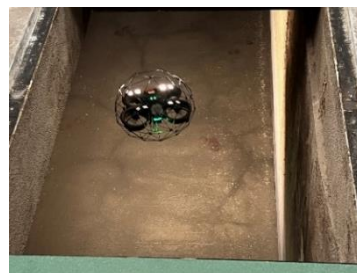
施設建屋内 BOX 部から投入する ELIOS 3
