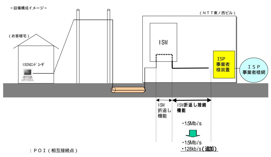
ISM(Iインターフェース加入者系モジュール装置):INSネット64およびINSネット1500の加入者を収容するISDN用加入者交換装置
