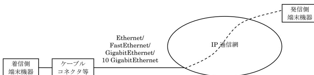
図 1-1 フレッツ・VPN ゲートの基本構成
