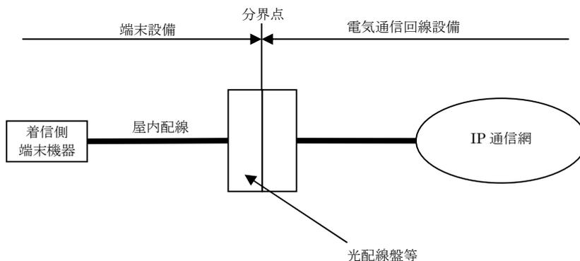
図 1-7 GigabitEthernet/10 GigabitEthernetタイプの分界点
