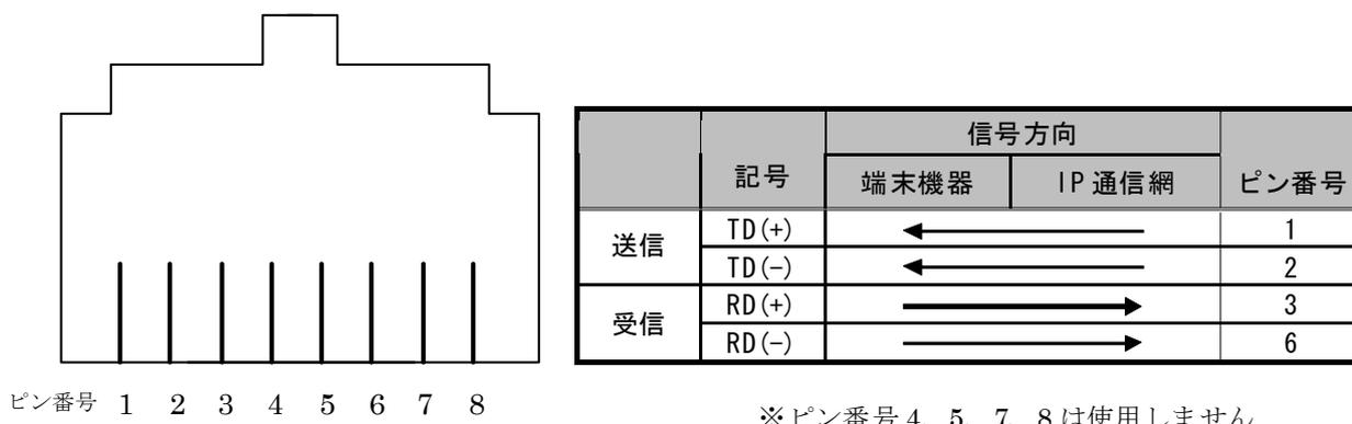
図 2-2 コネクタ先端面から見た RJ-45 コネクタのピン配置
