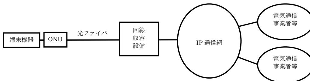
図 1-1 フレッツ 光ネクストの基本構成
