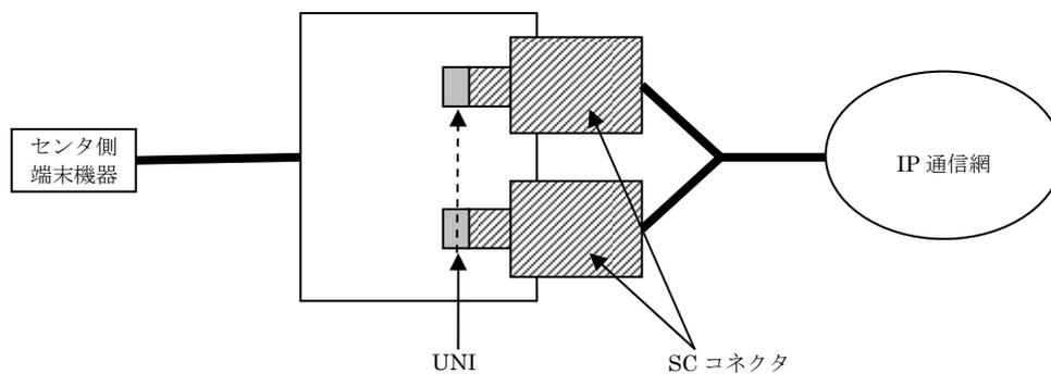
図 1-3 フレッツ・キャストのインタフェース規定点
