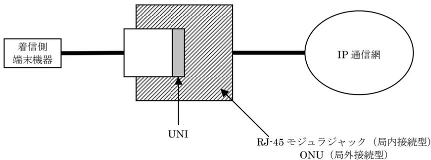
図 1-3 Ethernet/FastEthernetタイプのインタフェース規定点
