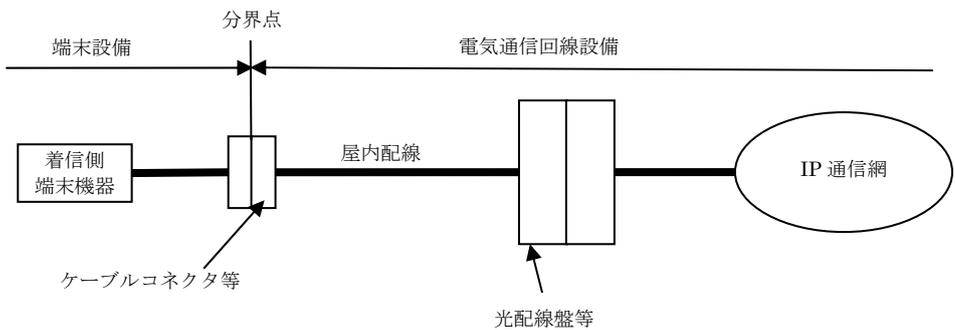
図 1-12 収容エリア内接続タイプの分界点
