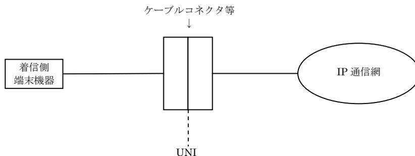
図 1-2 局内接続タイプのインタフェース規定点
