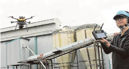
赤と緑の光線が照射される。鳥には餌に見えるという赤のレーザーで「誘引」し、鳥の視覚の痛感を刺激する緑の光で逃避行動を促し、クラスなどを追い払う仕組み。レーザーはランダムに回転しながら作動し、約30秒先ま
