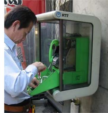
屋外に設置する公衆電話は、埃・熱、部品の摩耗等のため、故障が多い。戸外の通信手段を確保するため、故障修理に至急駆けつける。
