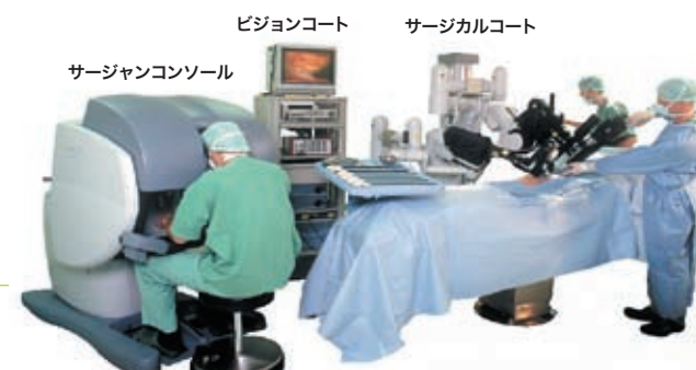
図1 ダヴィンチ装置はサーजनコンソール、サージカルコート、ビジョンコートの3つの構成要素からなるコンピューター制御の手術用のロボット。
