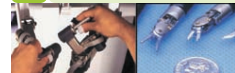
図4 独立した2画像（右：カメラ先端）により、外科医には高画質3次元映像（左）が提供される。
