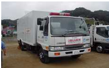
移動電源車による電力給電
