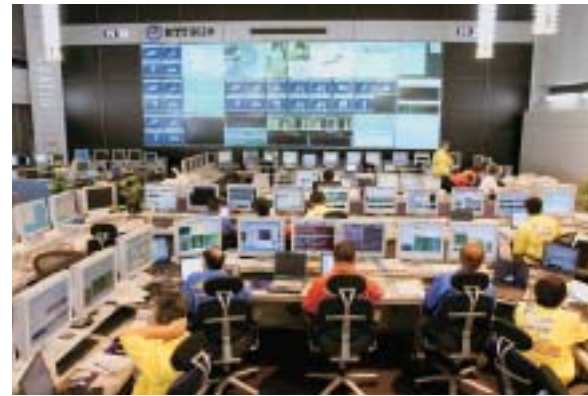
NTT東日本ネットワークオペレーションセンターでは、通信網のトラフィックを24時間リアルタイムで一元的に監視しており、通信設備や伝送路が被災した場合の状況確認などが可能
