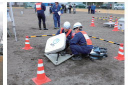
重要通信確保等において音声1chを伝送するKu-1ch
