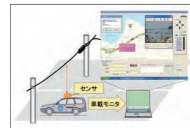
ケーブル地上高測定システム（イメージ）
