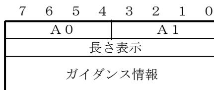
図2. 3. 10 接続パラメータ構成(発側ガイダンス情報)
