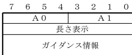
図2. 3. 11 接続パラメータ構成(着側ガイダンス情報)
