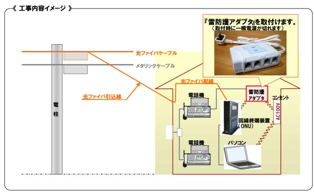
□ 雷防護アダプタの設置対象となるフレッツ光回線は、以下の回線となります。
