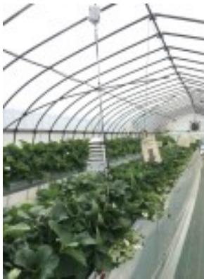
センサー (上部:照度 下部:温度・湿度)
